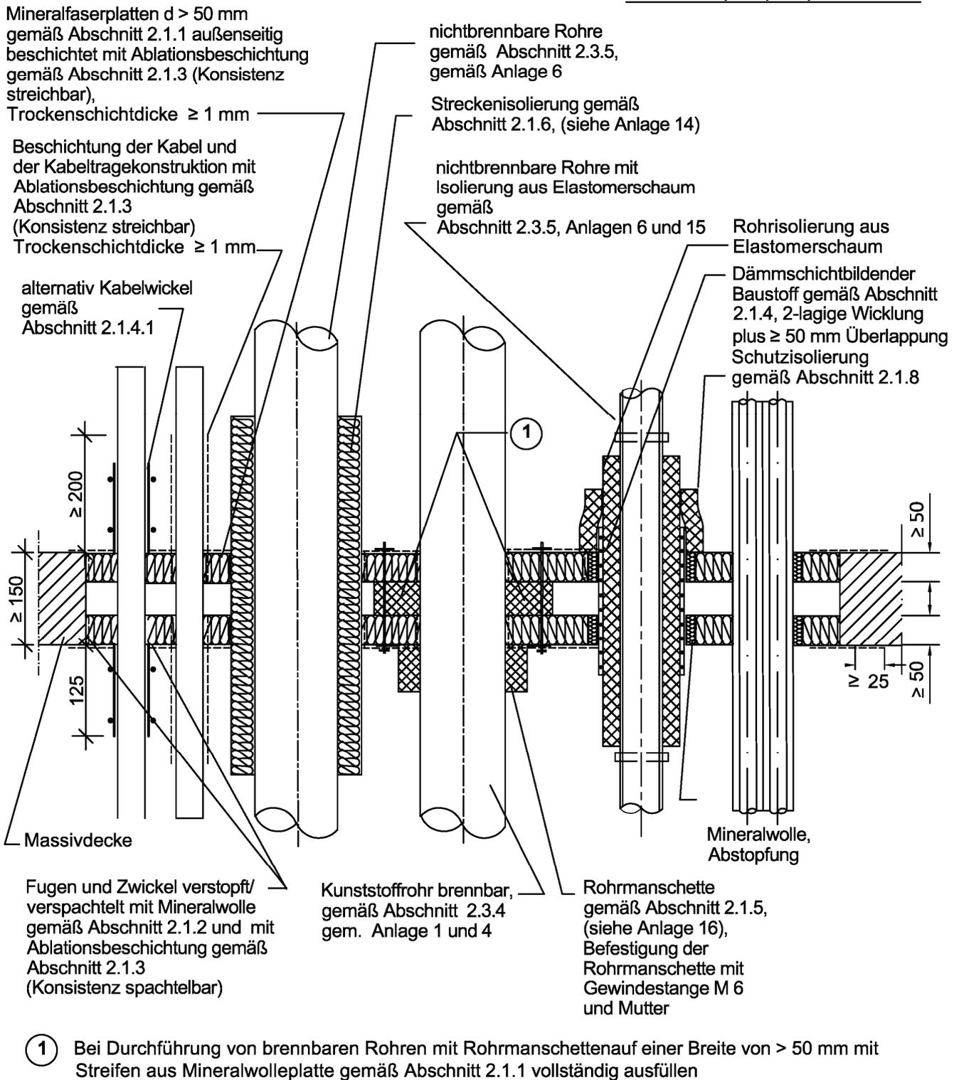
Feuerwiderstandsfähige Abschottung für elektrische Leitungen und/oder Rohrleitungen aus Kunststoff oder Metall "Flamotect COMBI 90"
