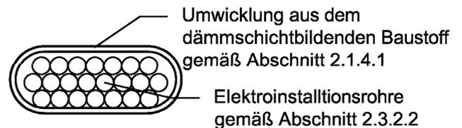
Feuerwiderstandsfähige Abschottung für elektrische Leitungen und/oder Rohrleitungen aus Kunststoff oder Metall "Flammotect COMBI 90"
