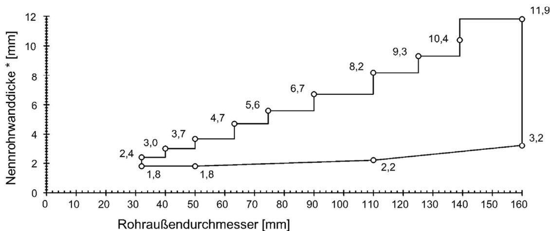
Rohre gemäß Rohrgruppe B der Anlage 1
