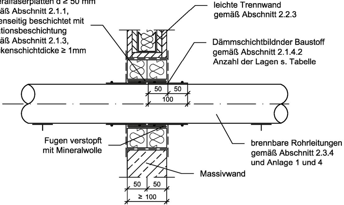
Mineralfaserplatten  $d \geq 50$  mm gemäß Abschnitt 2.1.1, außenseitig beschichtet mit Ablationsbeschichtung gemäß Abschnitt 2.1.3, Trockenschichtdicke  $\geq 1$  mm
