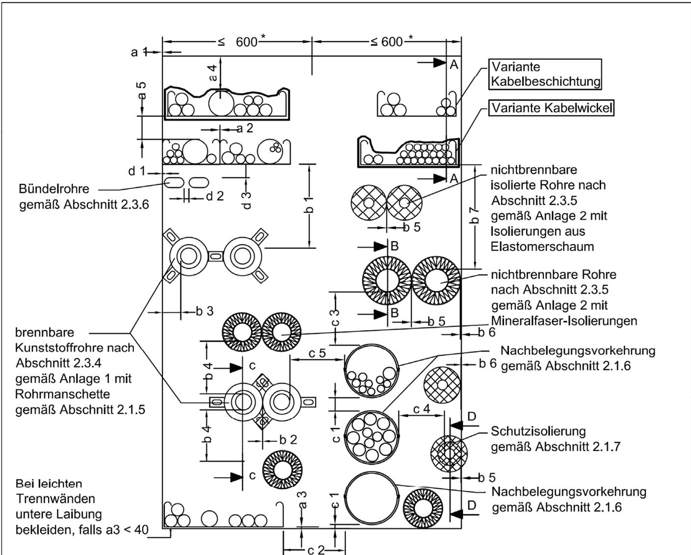
**Maximale Abmessungen der Abschottung:**
