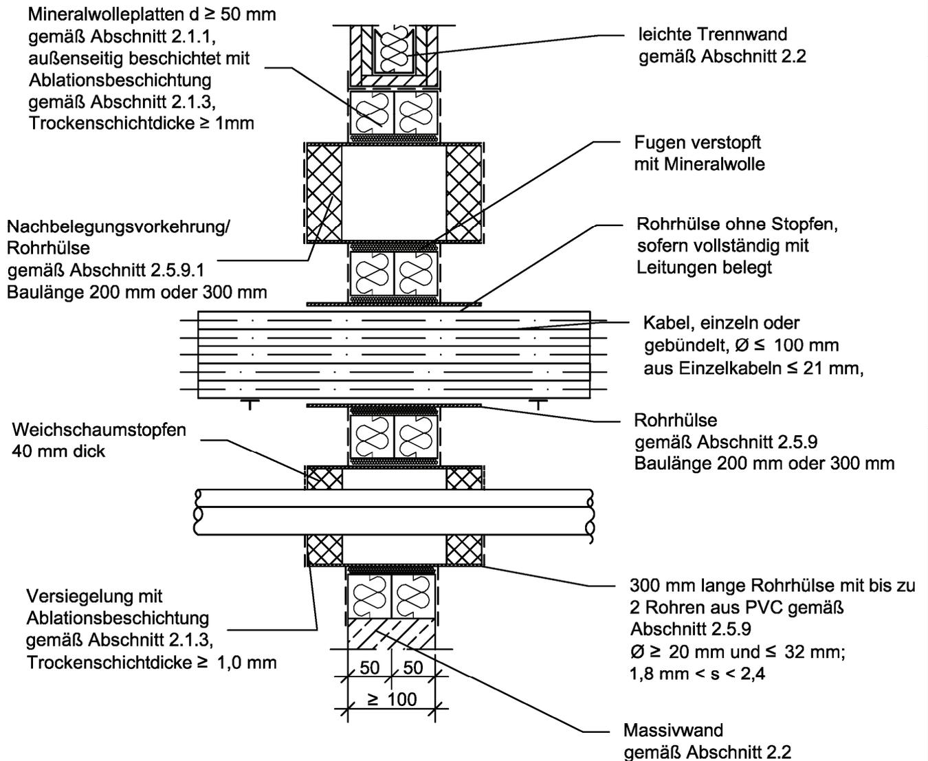
Feuerwiderstandsfähige Abschottung für elektrische Leitungen und/oder Rohrleitungen
