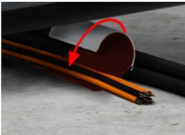
4. Cable Tube ML installieren. Die Bodenlasche muss unter den Kabeln/Rohren platziert werden.
