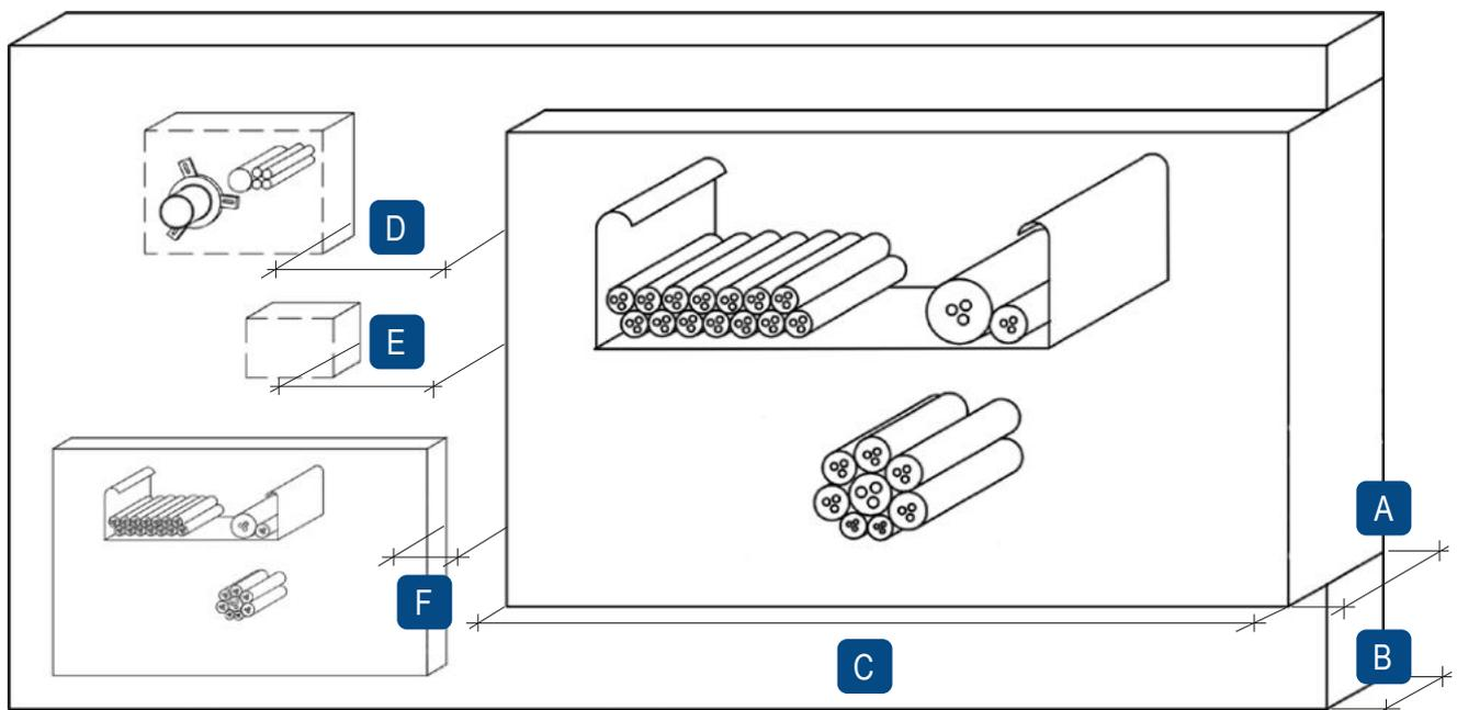
Der gesamte zulässige Querschnitt der Installationen (bezogen auf die jeweiligen Außenabmessungen) darf insgesamt nicht mehr als 60 % der Rohbauöffnung betragen.
