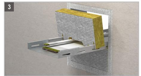
Die Öffnungen zwischen den Bauteillaibungen und den durchgeführten Kabeln und Kabeltragekonstruktionen sind mit passend zugeschnittenen Brandschutzplatten in zwei Lagen zu verschließen. Bevor die Platten in die Öffnung eingepasst werden, müssen die umlaufenden Randflächen der Platten zur Verklebung mit der Ablationsbeschichtung BMA eingestrichen werden. Die Beschichtungsdicke muss min. 1 mm betragen. Der Zwischenraum zwischen den beiden Brandschutzplatten braucht nicht beschichtet zu werden.
