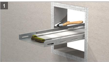
Zu Beginn sind die Laibungen der Bauteilöffnungen zu reinigen. Die Laibung muss mit der Ablationsbeschichtung BMA beschichtet werden. Die Trockenschichtdicke muss min. 2 mm betragen.
