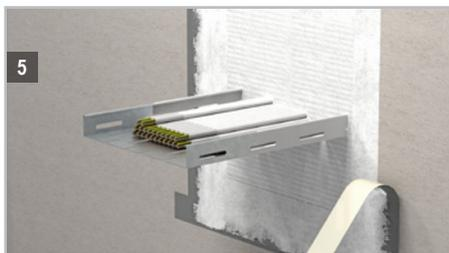
Anschließend ist jeweils auf der äußeren Seite ein ca. 30 mm breiter Streifen um die hindurchgeführten Installationen mit der Ablationsbeschichtung so zu beschichten, dass die Trockenschichtdicke min. 2 mm beträgt.
